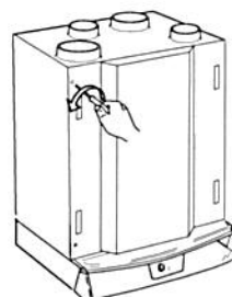
Figur 7. Öppning av aggregatluckan.
