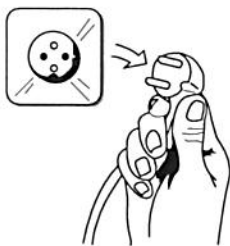
Figur 12. Före rengöring av värmeväxlare och fläktar etc skall aggregatet alltid göras spänningslöst.
