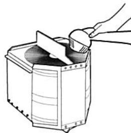
Figur 15. Värmeväxlaren dammsugs från båda sidor.
