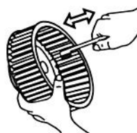
Figur 18. Fläkthjulets kåpa och fläktvingar rengöres med en borste.
